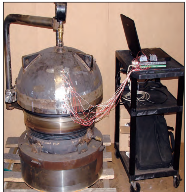
Prueba hidrostática de la tapa CL900V de 24 in. a 3350 psi
